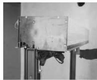
2. Falls es unmöglich sein sollte auf die oben aufgeführte Weise den Kasten aufzuschieben (z.B. wegen unkorrekt montiertem Adapter zum Fensterrahmen), sollte man den Kasten auf den Adapter von der Seite anschieben. **VORSICHT! Bitte auf den Seitenkasten mit keinerlei hartem Gegenstand schlagen.**
